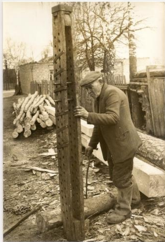
w. Jenorożec, pow. Przasnysz Łada - przyrząd do podnoszenia kłoców drzewa na wóz lub na stołki traczne. fot. M. Pokropek, 1956
